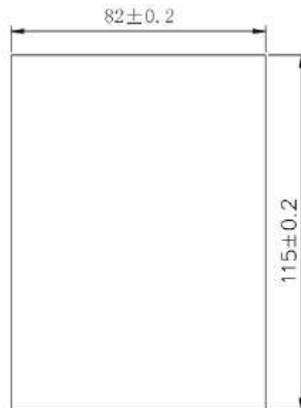
Рисунок А. 13. Установка большой панели
