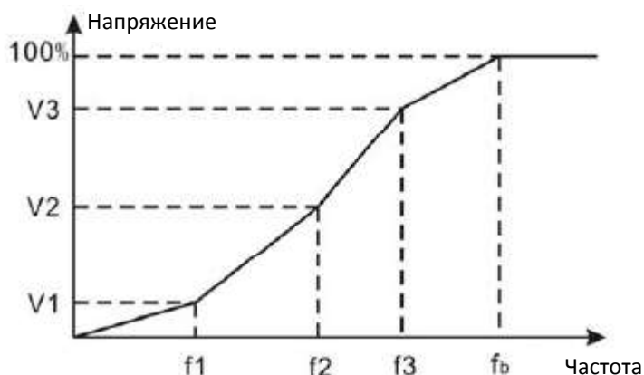
Рисунок 6.10. Установка параметров для пользовательской вольт-частотной характеристики
