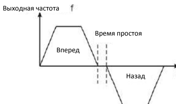
Рисунок 6.5. График задержки переключения вперед-назад (FWD/REV)
