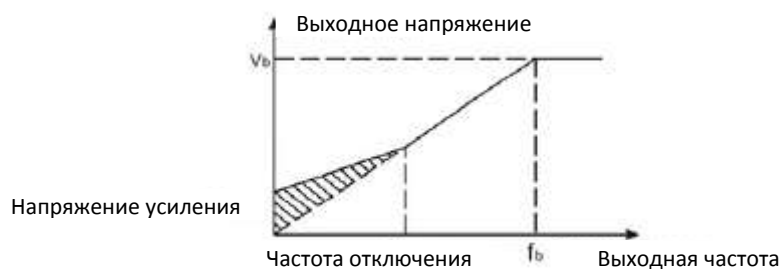
Рисунок 6.9. Характеристика для «ручного» усиления крутящего момента
