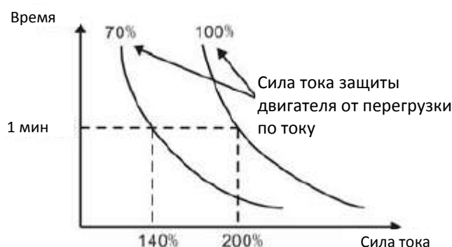
Рисунок 6.32. Кривые защиты двигателя от перегрузки по току.
