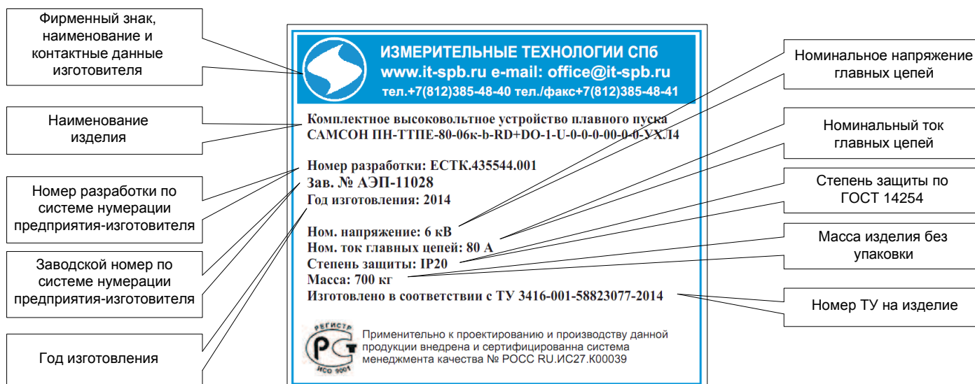
Рисунок 2.10. Обозначения на электротехнической табличке
